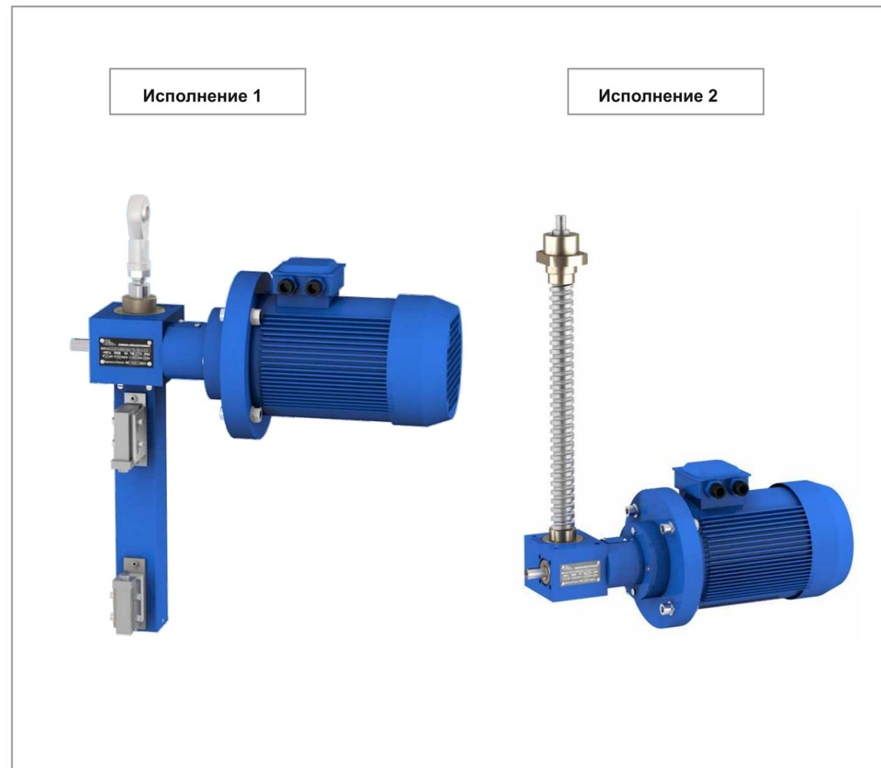
В зависимости от типа силовой передачи применяемой для преобразования вращательного движения в поступательное, винтовые домкраты могут быть **статически самотормозящимися (ПВД)** или **статически не самотормозящимися (серия ПВДК)**.
